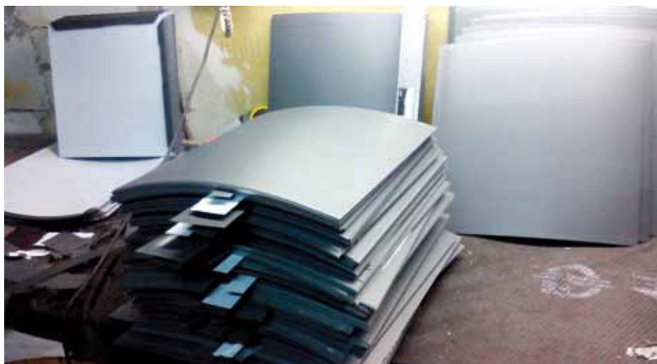
▲ Kilka z 3600 tusek ułożonych na dachu – każda została wykonana ręcznie
